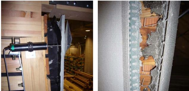
写真1 モルタルの剥離 写真2 コーナー部の破断
