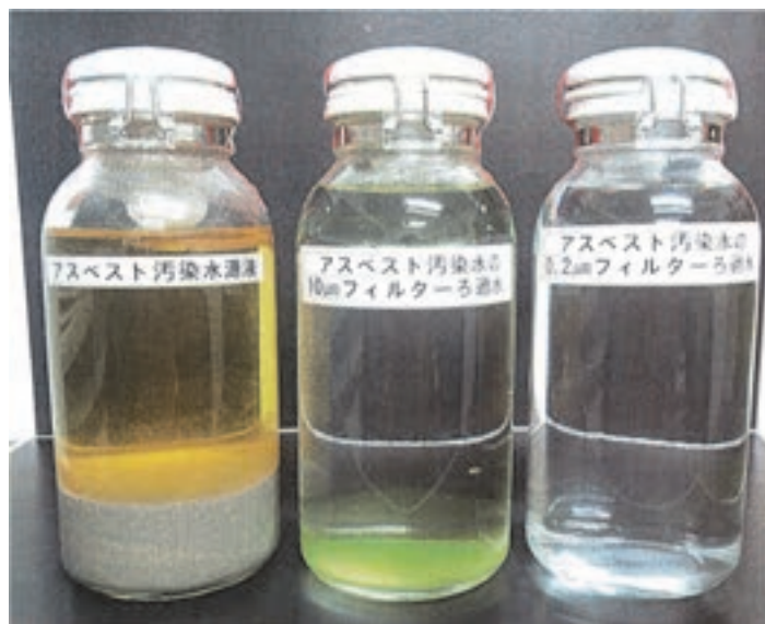
写真10 処理水等の外観
