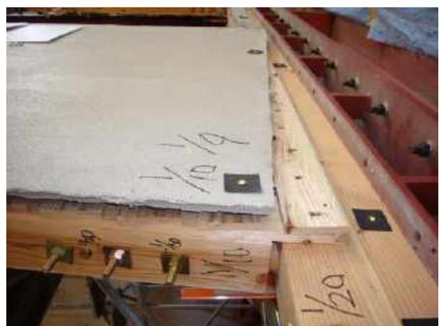
写真 3.2.23 No.2 壁脚部モルタル剥離状況
