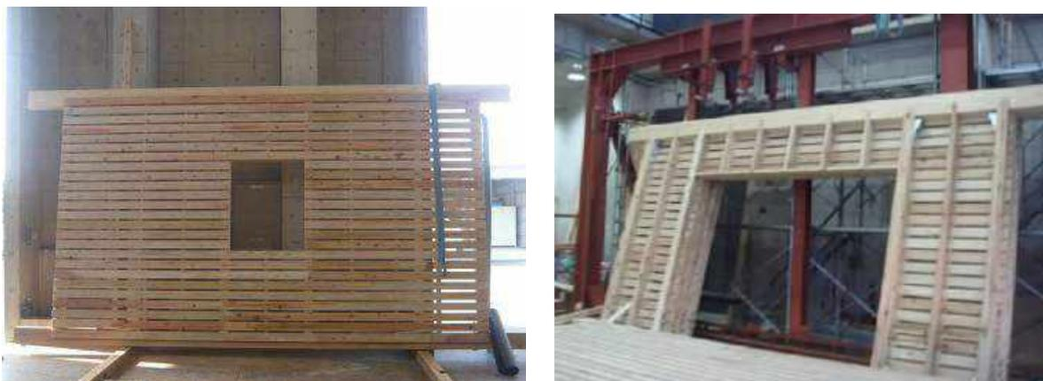
写真 3.2.2 軸組の概要
