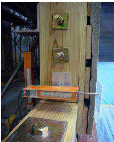
写真 3.2.17 モルタル面外変位の測定
