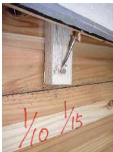
写真 3.3.46 N65 の抜け・変形
