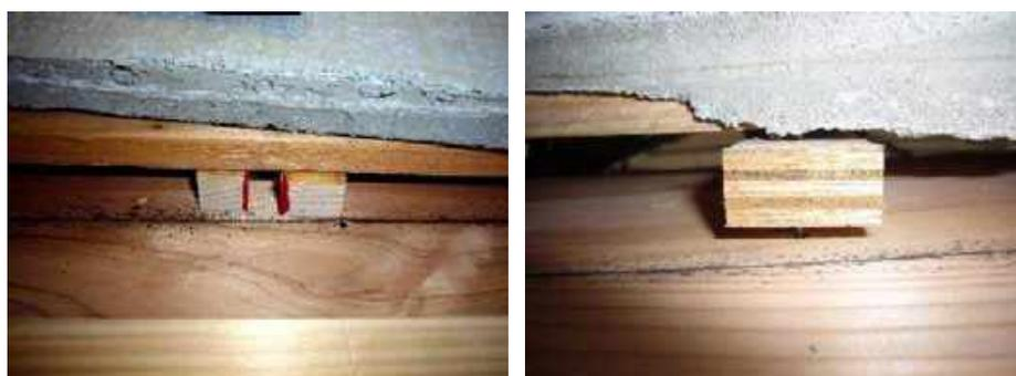
写真 3.3.45 通気胴縁の破壊状況(左:すぎ製材,右:合板)
