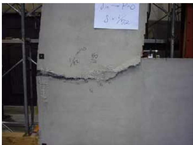
写真 3.2.39 No.6 左下側破断状況
