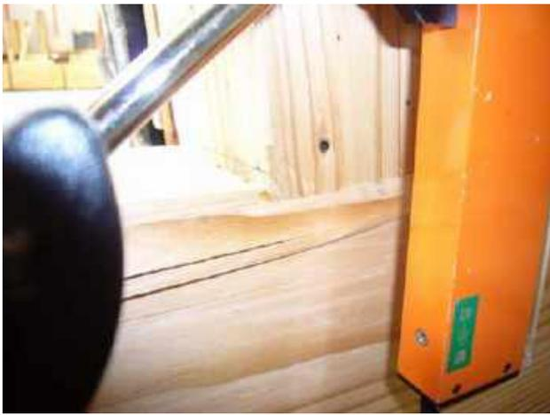
写真 3.2.30 No.3-a4 柱脚圧壊
