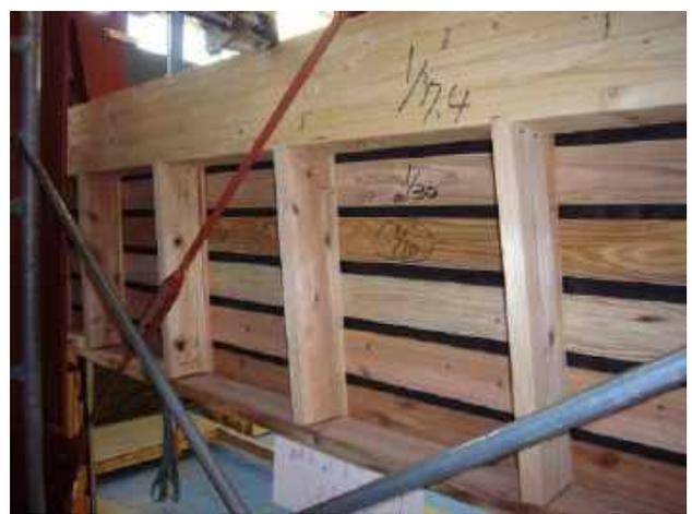
写真 3.2.33 No.3-h 垂壁の胴縁破壊
