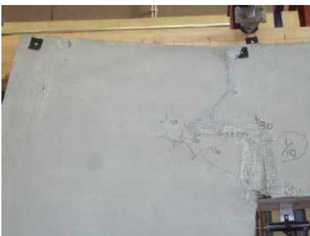
写真 3.2.32 No.3-h 開口上隅破壊状況
