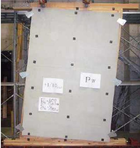
写真 3.3.40 構造用合板下地試験体(1/10rad)
