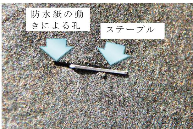
写真 4.2.2 防水紙の寸法変化による孔
