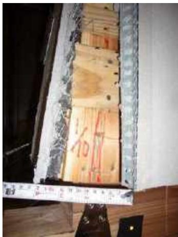
写真 3.3.25 釘抜け/ステーブル抜け状況
