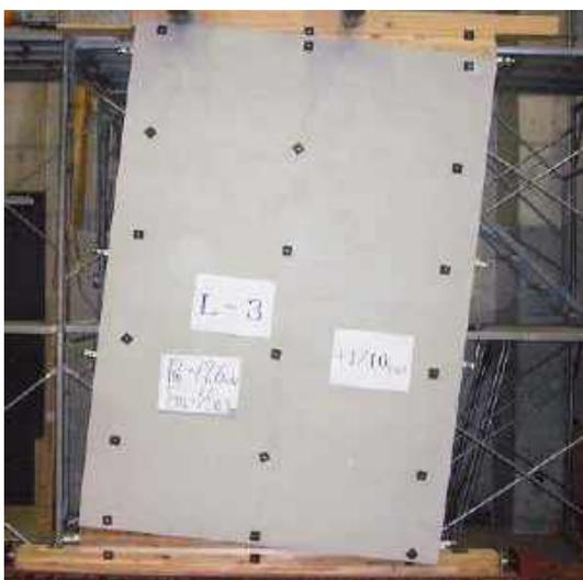
写真 3.3.38 ラス下地板下地試験体 (1/10rad) 引抜け
