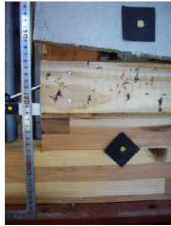
写真 3.3.20 モルタル回転・ステープレ拔出し
