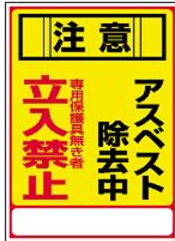
「関係者以外の立入禁止」の表示 (石綿障害予防規則 第15条)
